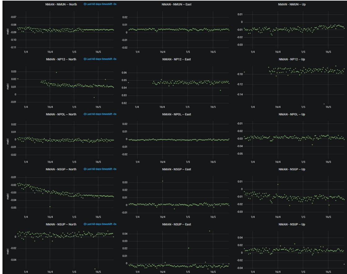
Figura 38 - Serie temporali delle componenti di spostamento delle stazioni di monitoraggio GNSS dell'INGV.
