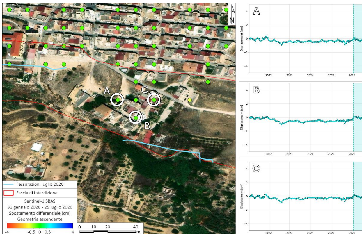
Figura 39 - Mappa degli spostamenti differenziali registrati dai dati Sentinel-1 in geometria ascendente, elaborati con tecnica SBAS, nell'intervallo di tempo 31 gennaio 2026 - 25 luglio 2026, nell'area circostante via Ustica. A destra, le serie temporali dei punti evidenziati in mappa.
