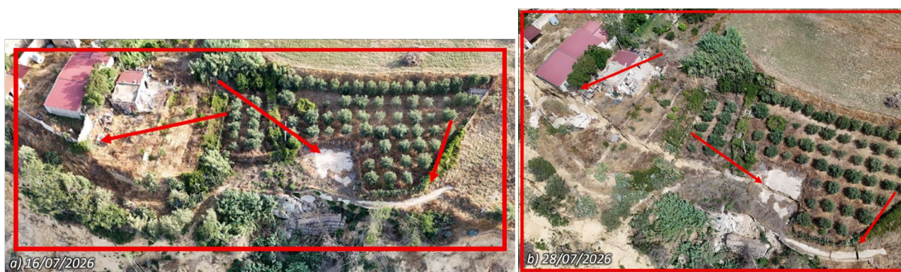
Figura 5 - Confronto fotografico del fronte di scarpata all'altezza di via Ustica: (a) 16 luglio 2026; (b) 28 luglio 2026. Le frecce rosse evidenziano a scopo illustrativo alcuni punti omologhi nelle due foto. Foto fornite da DPC
