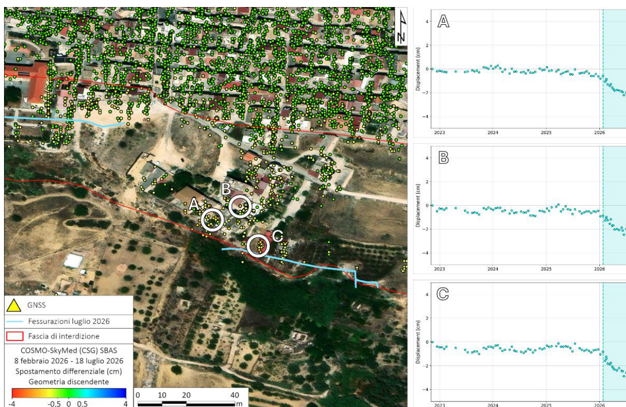
Figura 42 - Mappa degli spostamenti differenziali registrati dai dati COSMO-SkyMed in geometria discendente, elaborati con tecnica SBAS, nell'intervallo di tempo 8 febbraio 2026 - 18 luglio 2026, nell'area circostante via Ustica. A destra, le serie temporali dei punti evidenziati in mappa.
