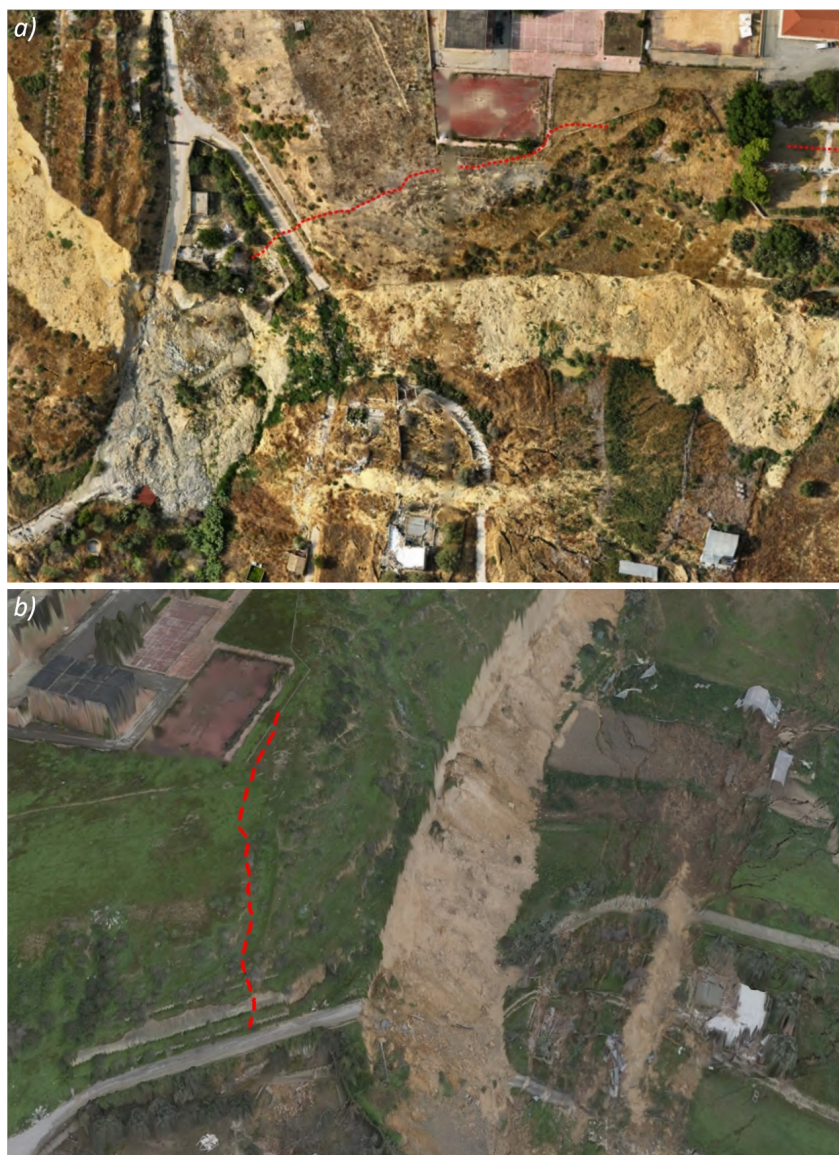
Figura 2 - Ubicazione e traccia della fessura antistante il plesso scolastico San Giuseppe (tratteggio rosso); (a) ortofoto da drone di luglio 2026; e (b) modello digitale del terreno generato mediante rilievo drone di gennaio 2026.
