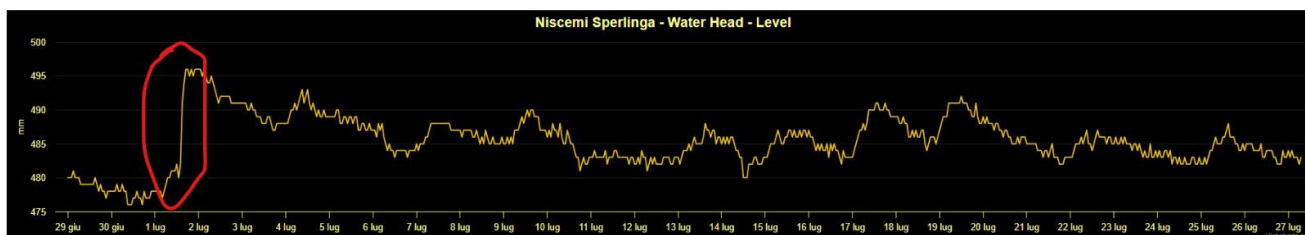
Figura 15 - Livello piezometrico registrato dal sensore di Niscemi-Sperlinga nel periodo 29 giugno - 27 luglio 2026. Il cerchio rosso evidenzia l'incremento di 16-20 cm corrispondente al nubifragio del 1° luglio 2026.
