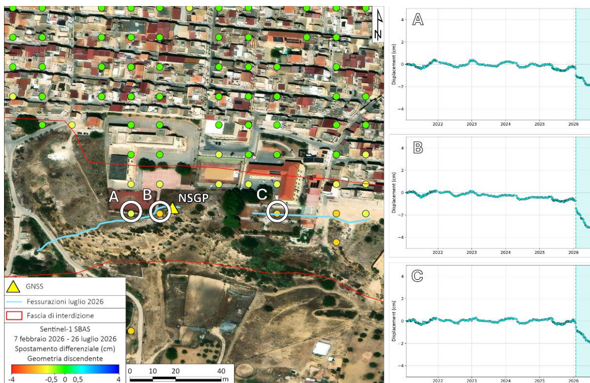
Figura 35 - Mappa degli spostamenti differenziali registrati dai dati Sentinel-1 in geometria discendente, elaborati con tecnica SBAS, nell'intervallo di tempo 7 febbraio 2026 - 26 luglio 2026, nell'area circostante il plesso scolastico San Giuseppe. A destra, le serie temporali dei punti evidenziati in mappa.
