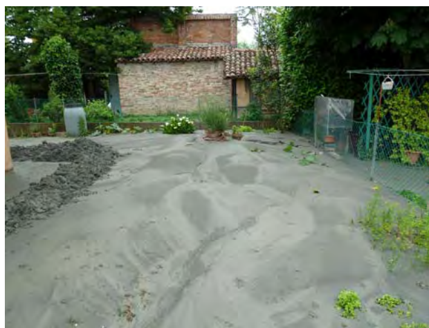
Fig. 9 – San Carlo. Cedimento differenziale di un edificio misto in c.a. e muratura per liquefazione con sviluppo di lesioni di livello 3. A destra, poco lontano, evidenze di liquefazione di sabbie eiettate da un pozzetto.
