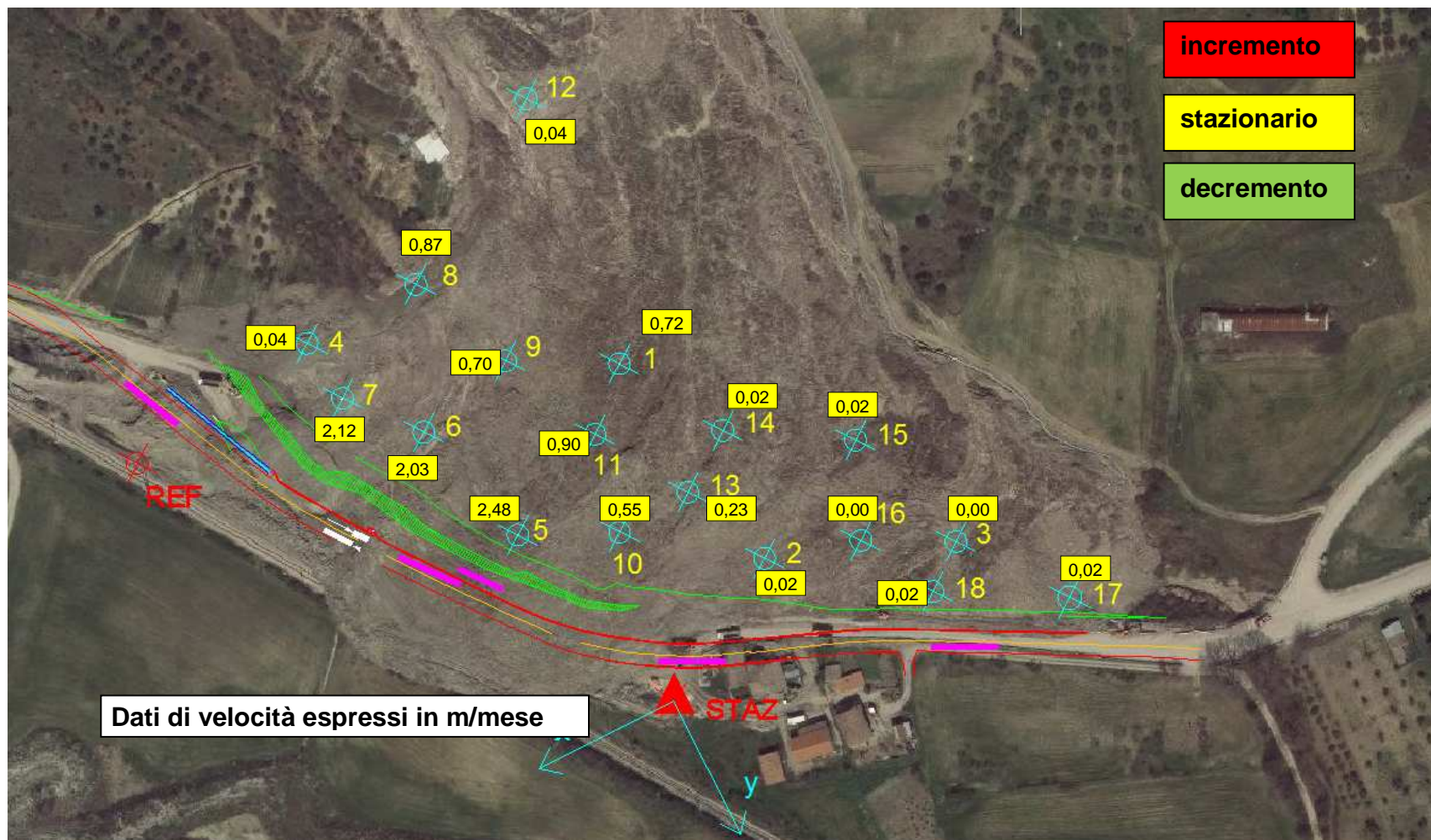
Visione d'insieme del sistema monitoraggio attivo al piede della frana con la proiezione della viabilità provvisoria sulla foto area ante-sistemazione. Nell'immagine vengono riportati i tassi di movimento complessivi (m/mese) del mese di gennaio; dal prossimo bollettino mensile si provvederà anche a fornire una valutazione circa le tendenze (incremento/decremento) rispetto al mese precedente.
