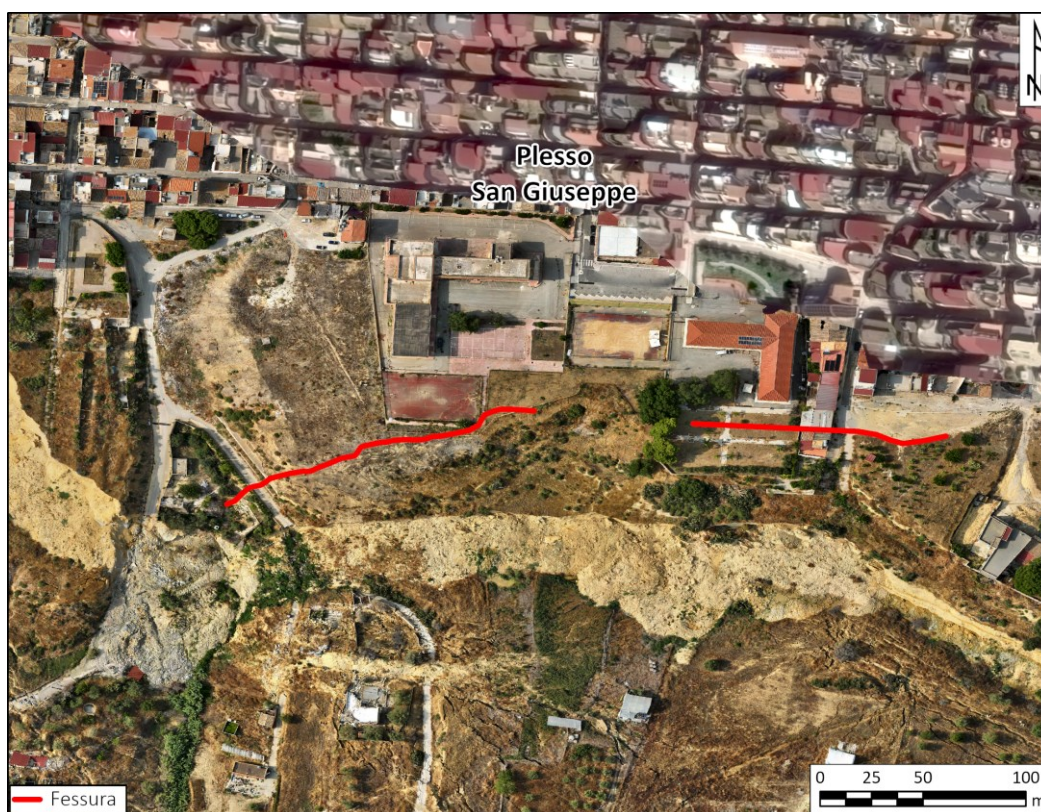
Figura 21 - Ubicazione delle fessure di neoformazione (in rosso) in corrispondenza del plesso scolastico San Giuseppe, oggetto dell'intervento provvisorio di impermeabilizzazione. Base cartografica: rilievo aerofotogrammetrico da drone eseguito dalla Fondazione CIMA nel luglio 2026.
