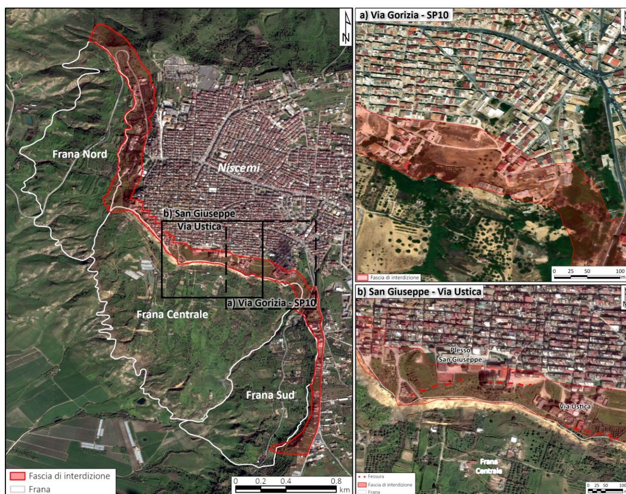
Figura 12 - Ubicazione dei due settori oggetto di approfondimento: a) via Gorizia - SP10 e b) San Giuseppe - via Ustica. La campitura rossa indica la fascia di interdizione vigente. Le linee rosse tratteggiate mostrano le principali fessurazioni sul terreno.
